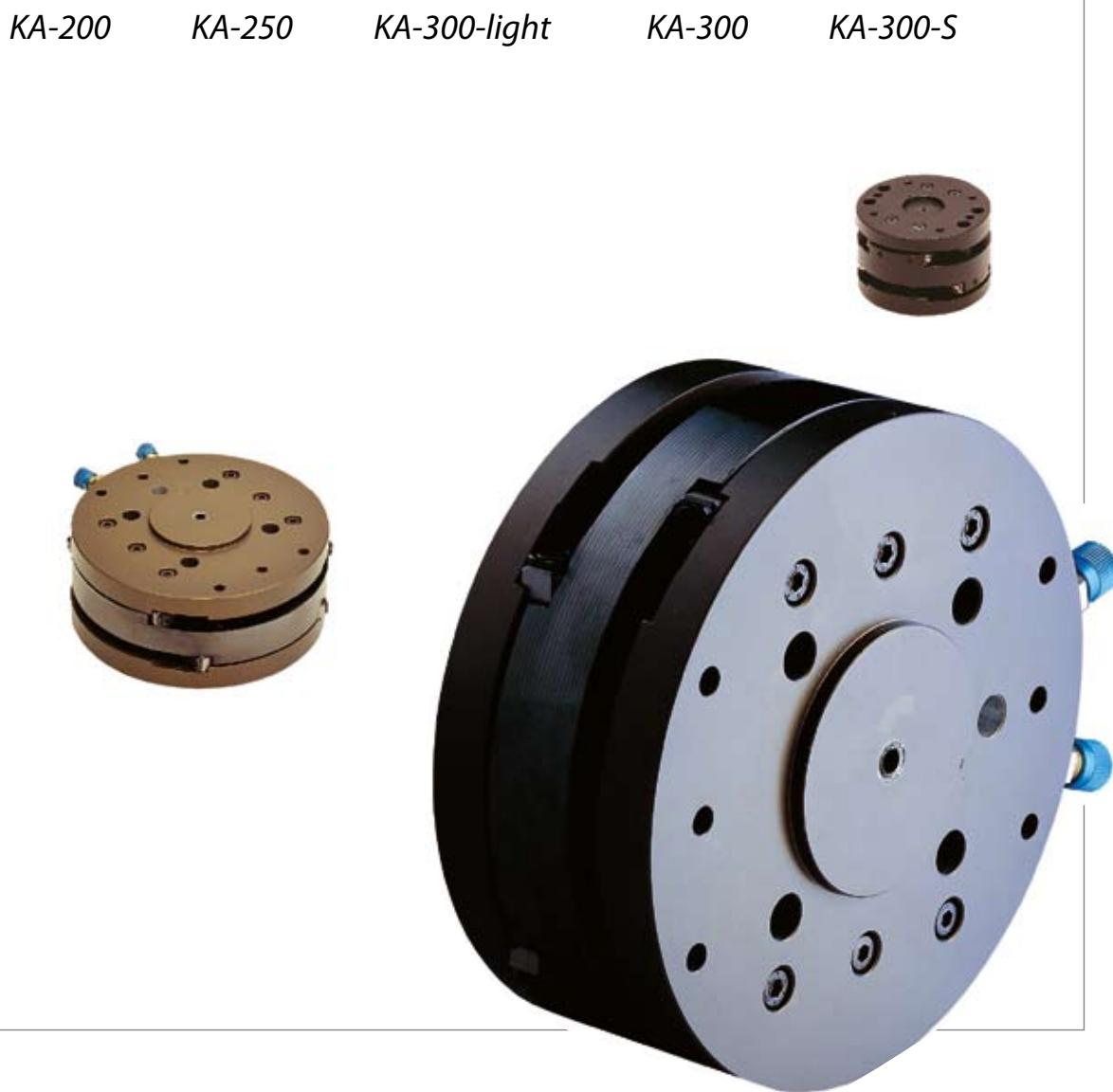
*Le paramètre déterminant pour le choix d'une compliance sans effort est le couple admissible. Il faut également prendre en compte les efforts additionnels de traction et compression qui peuvent engendrer des couples sur les guidages. Le couple max. est défini par la force de la masse de la pince et de la pièce, des mouvements de translation du robot et éventuellement des efforts lors de la prise et dépose de pièce.*
